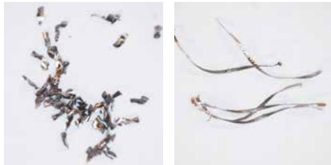
L'insertion d'un brise copeau dans le foret réduit sensiblement leur longueur et permet ainsi d'éviter les risques de rayures sur les pièces
