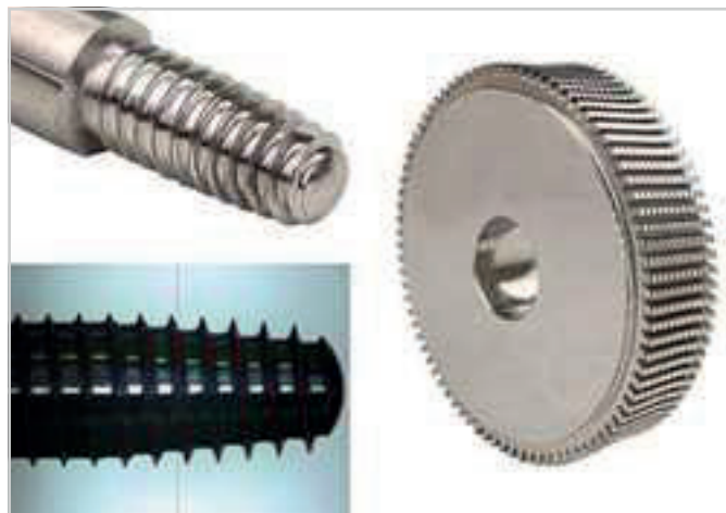
Le polygonage permet de réaliser une grande partie des filetages d'implants.
