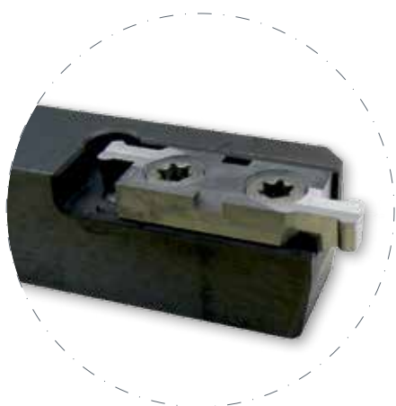
Bulino multifunzione con inserto profilato
