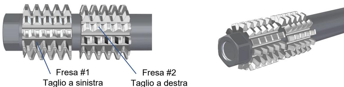
La prima operazione di dentatura viene effettuato con il creatore #1. Fresatura frontale, fresatura a tuffo sulla faccia A fino all'uscita sulla faccia B.
